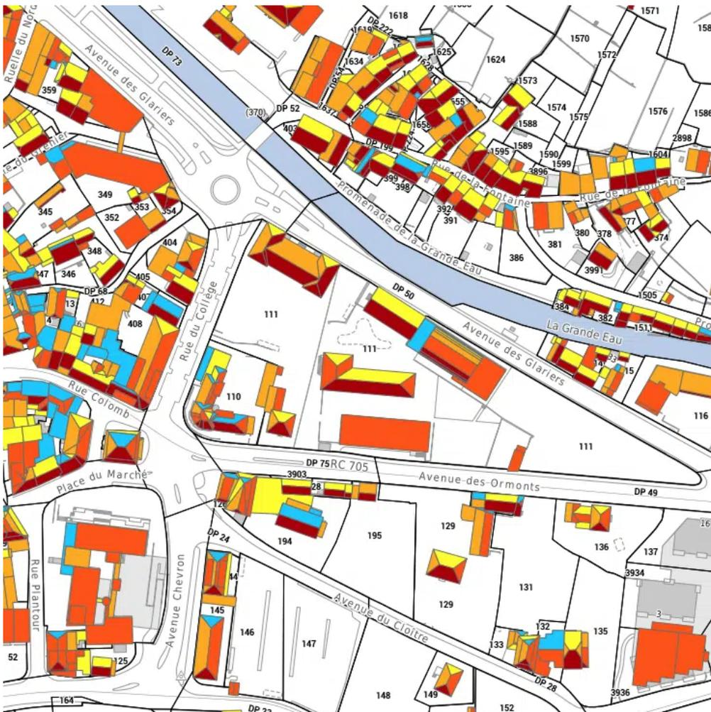
Le cadastre solaire permet de mettre en évidence les surfaces des toits qui sont adaptées pour l'installation de panneaux solaires, thermiques ou photovoltaïques.
